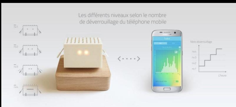
Le nombre de déverrouillages du téléphone mobile de l'utilisateur est capté via une application installée sur le smartphone et cette donnée est enregistrée en temps réel puis restituée et répartie en 4 niveaux (voir l'image ci-dessus)
