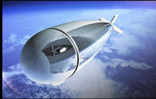
compléter la capacité des réseaux de télécommunications permettant de fournir de la 4G, et bientôt la 5G. La position stratosphérique à 20 kilomètres d'altitude lui permettra de disposer d'une zone de couverture régionale. En effet, une telle altitude permettra d'obtenir de larges couvertures, tout en s'assurant de temps de latence plus courts que via les satellites, en particulier les satellites géostationnaires, qui restent pénalisés par des latences nettement plus élevées.
